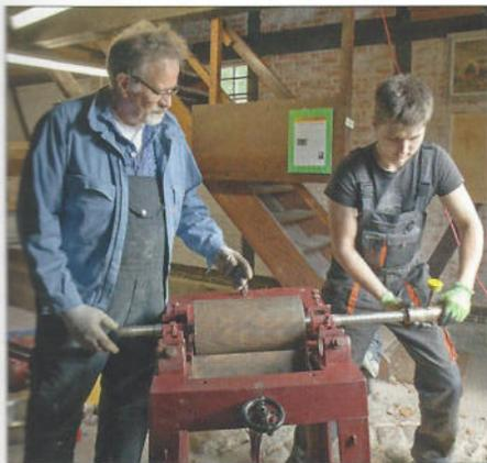
Meistens wurden die demontierten Teile mit nach Hause genommen und in der Kellerwerkstatt überarbeitet. Zum Beispiel war das Fett in den Lagerbuchsen im Lauf der Jahre verhärtet, so dass es sich nur noch mit dem Meißel entfernen ließ, die Schmierkanäle mussten sogar aufgebohrt werden.
